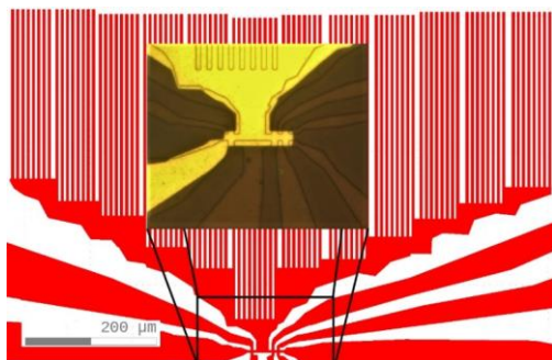
Рис. 1. – Фотография и дизайн образца с длинным краем (периметр длинного края 50мм). Жёлтым цветом показана область, покрытая металлическим затвором.
